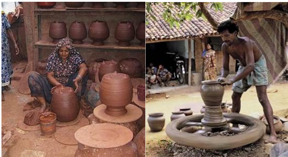
印度常駐陶工以盤泥及轆轤拉坯製作日用器
