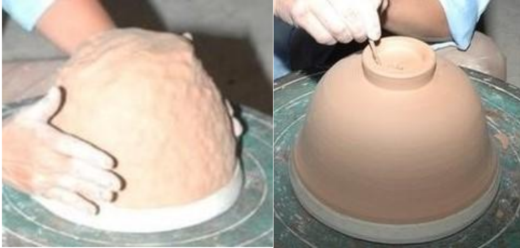
「陽模」製圓器 - 以泥覆在模上拍打成，脫模修坯成器形。
