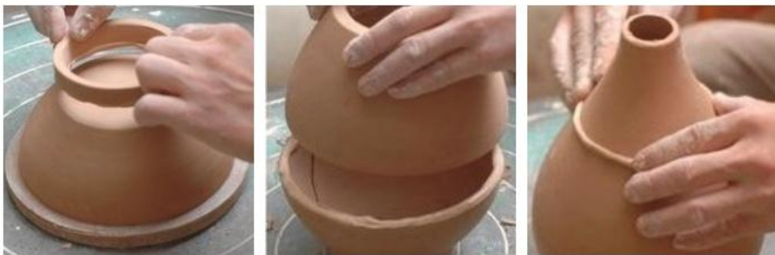
「陰模」接胎玉壺春 - 脫模後黏上圈足（左）底腹接合（中）頸腹接合（右）
