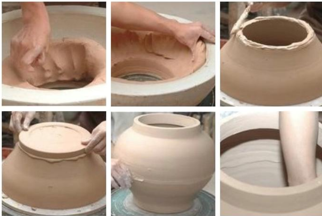
「陰模」製大罐過程自左至右 - 鋪泥、壓模、脫模、接底、接胎、修坯。
