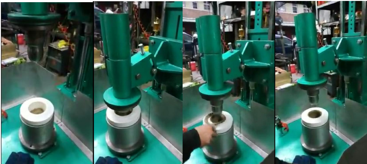
左起：1. 旋坯機及石膏外模 2. 壓下旋轉模芯成形 3. 修去多餘泥料 4. 完成並提起模芯
