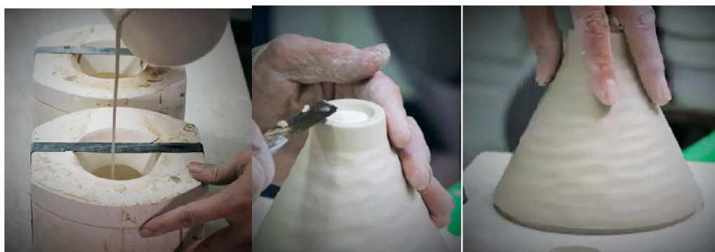
注漿入夾層模(左) 脫外模後修去注口披鋒(中) 提起脫內模(右)
