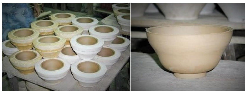
旋坯半成品在外模內乾燥成形(左) 及脫模後成澀坯(右)
