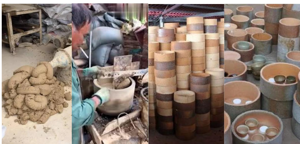
自左至右：製匣鉢泥料，模具手工製鉢，備用匣鉢，裝鉢實況
